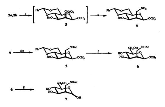
c) NaBH<sub>4</sub>-EtOH 0°C; d) LiAlH<sub>4</sub>-THF (reflux, 2h); e) Ac<sub>2</sub>O-MeOH; f) H<sub>2</sub>, Pd/C, EtOH-dioxane; g) 0.01n HCl, 60°C (30 min)
